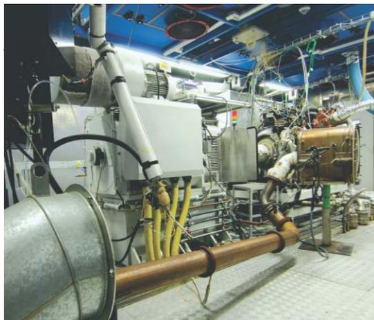
Dinamômetro de motores diesel (620 kW)
